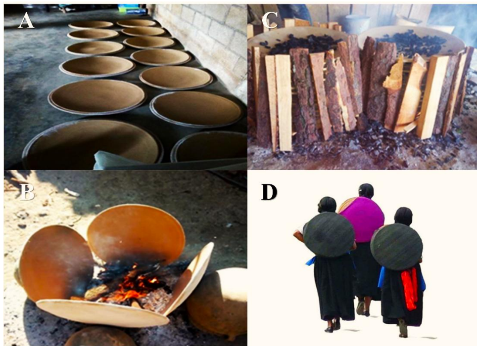
Figura 5. A) Secado de los comales, B) Pre-cocción de los comales, C) Horneado de los comales, D) Forma de transportar los comales.
