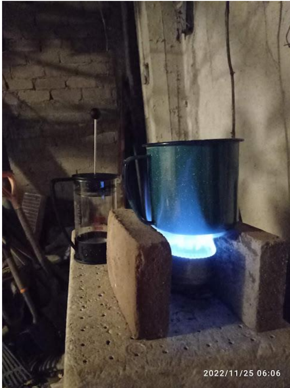
Estufa funcionando con biogás en Santa Cruz Xoxocotlán, Oaxaca
